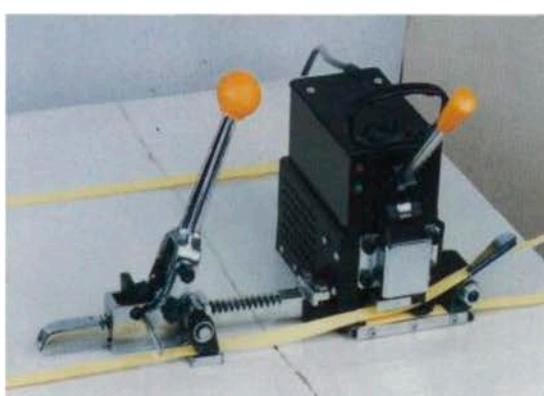
Рис.3 Прижмите корпус аппарата левой рукой а правой рукой нажмите переднюю ручку (13) вниз до конца! Обрезка и запайка произойдет в течение 2 секунд. Когда загорится желтая лампочка отпустите переднюю ручку, чтобы вернуть ее в первоначальное положение.
