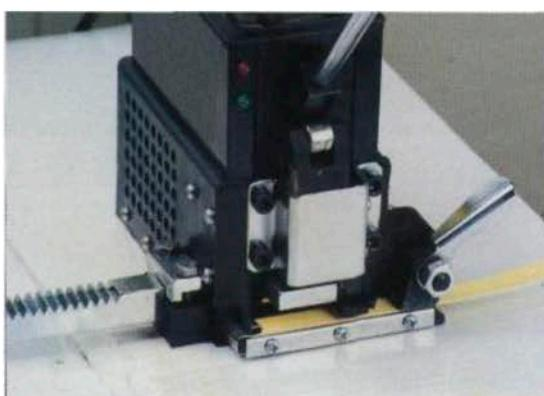
Рис.2 Одним концом ленты по кругу обмотайте упаковываемый продукт , другой конец положите горизонтально под задний прижим (12);наклоните вперед заднюю ручку(14), плотно натяните ленту вокруг упаковываемого продукта и вставьте другой конец ленты между нижним(9) и верхним ножом(10).
