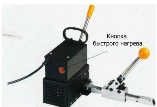
Рис.1 Включите машину и поверните ручку быстрого нагревания, через 2 минуты можно начать работу. Вставьте конец пластиковой ленты под пружиной (7) и положите горизонтально под передний прижим (11).
